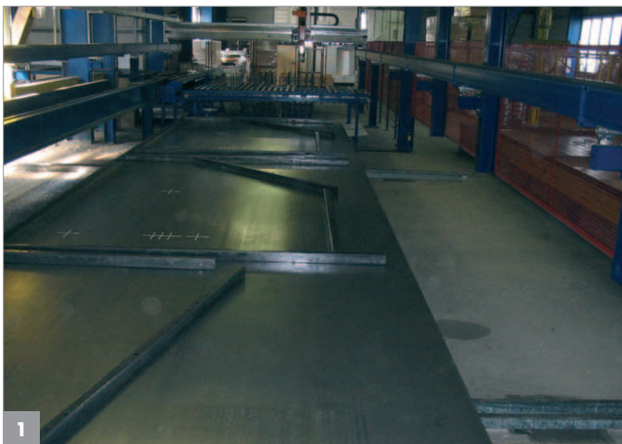
Bei der Produktion der Elemente konnten die Vorteile des neuen Multi-Funktions-Schalungsroboters voll ausgenutzt werden.
